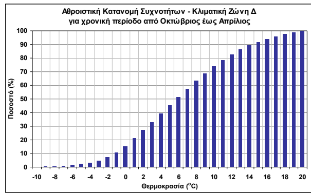
Σχήμα 2.4. Αθροιστική κατανομή συχνοτήτων θερμοκρασίας εξωτερικού αέρα για την Κλιματική Ζώνη Δ.
